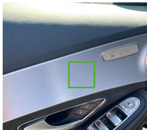
Geringfügige Beschädigung der Kunststoffverkleidung
